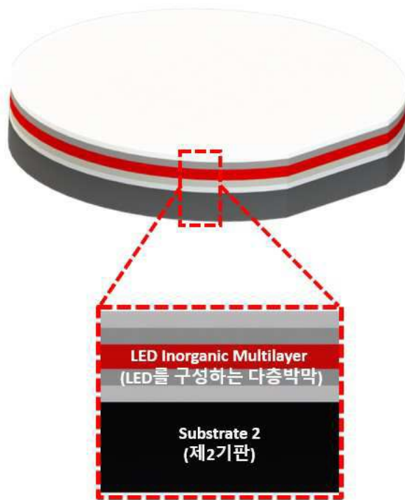
(c) LED Layer on Substrate 2 (제2기판에 LED를 구성하는 다층박막 형성)
